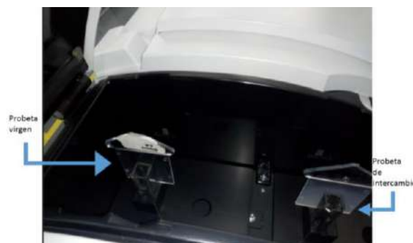
Figura 4 Colocación de probetas en equipo de UV/Visible
