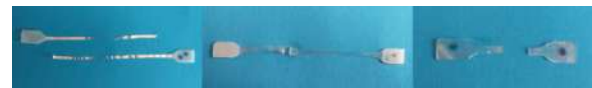
Figura 4. Tipos de roturas de las probetas de los poliuretanos: a) formación de zonas cristalinas, b) formación de zona transparente y c) rotura instantánea
