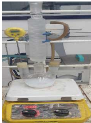
Figura 2 Sistema para la modificación superficial de la sílice hidrofílica.
