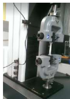
Figura 5. Pruebas de tensión en la máquina de pruebas universales
