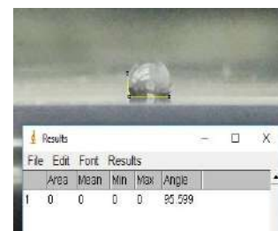
Figura 6 Foto de ángulo de contacto de la placa recubierta con una dispersión THF/IPA(50:50)-sílice hidrofílica.
