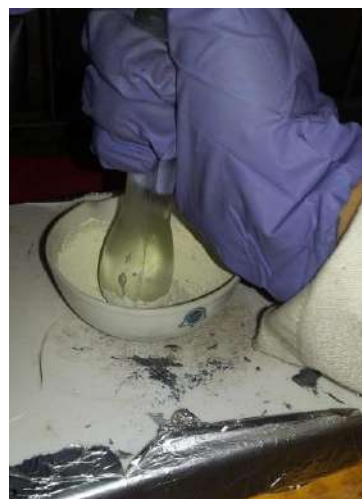
Fig. 3. Molienda manual para la obtención de la p-DIDA
