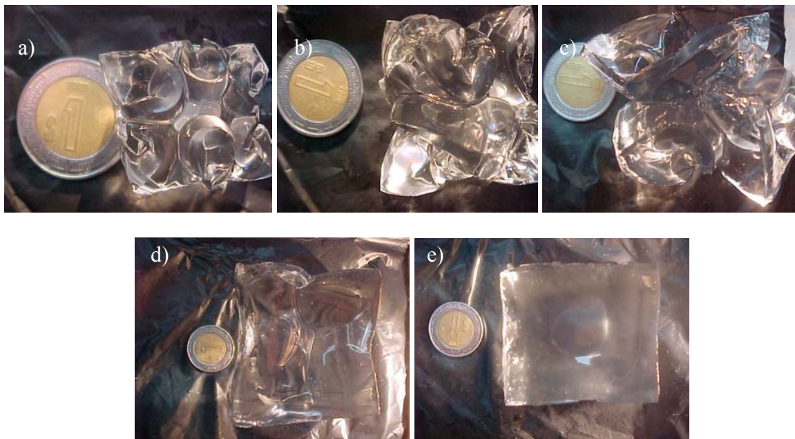
Figura 5 Macroestructuras de hidrogeles con 0.5 % de reticulante, hidratados a distintos tiempos a) 1 h, b) 3 h, c) 7 h, d) 24 h y e) 33 h.
